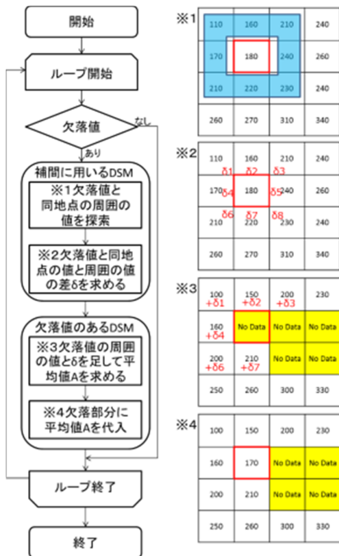
図-4 他のDSMを用いた補間処理の手順
