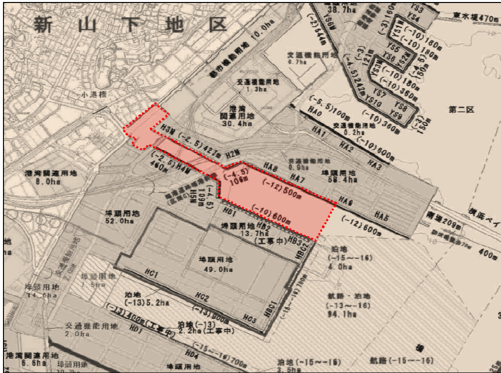
図 4.1 突堤間を災害時海面処分場候補地とする例（横浜港本牧 A～B 突堤間）
