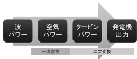
図1 OWC装置のパワー変換過程
