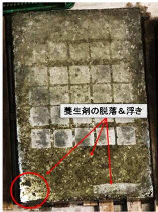
写真-7 養生剤B（ワックス系）の脱落・浮き
